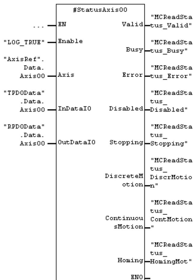
Im Stat-Bereich eines Container-FB's instanzierter MC\_ReadStatus\_E2 mit dem Instanznamen StatusAxis00.
