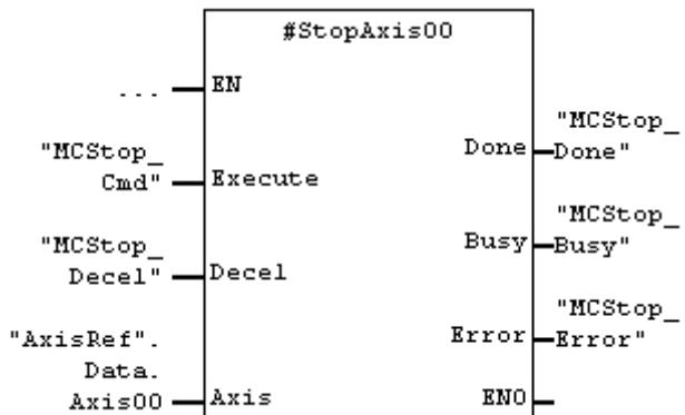
Im Stat-Bereich instanzierter MC\_Stop\_E2 mit dem Instanznamen StopAxis00.
