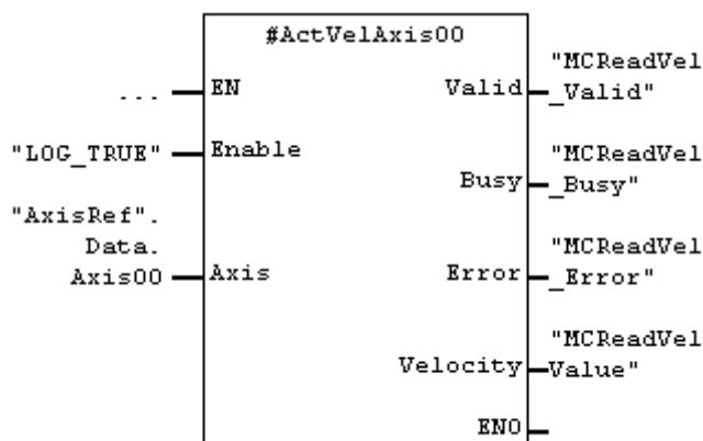
Im Stat-Bereich eines Container-FB's instanzierter MC\_ReadActualVelocity\_E2 mit dem Instanznamen ActVelAxis00.
