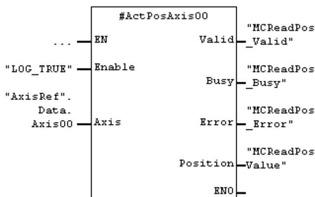
Im Stat-Bereich eines Container-FB's instanzierter MC\_ReadActualPosition\_E2 mit dem Instanznamen ActPosAxis00.
