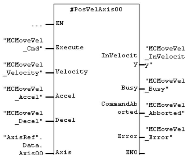
Im Stat-Bereich instanziierter MC\_MoveVelocity\_E2 mit dem Instanznamen PosVelAxis00.
